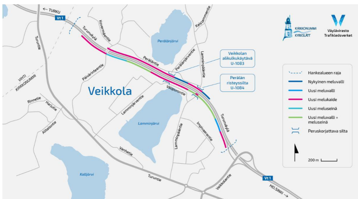
Bild 1. Utdrag ur illustrationskartan i planen för bullerskydd längs riksväg 1, som genomfördes som ett gemensamt projekt mellan Trafikledsverket och Kyrkslätt kommun (skede 1) år 2020. Genom projektet förbättrades bullerbekämpningen vid byn Veikkola som är belägen längs riksväg 1 med nya bullerskydd. Därtill gjorde man inom projektet en grundläggande renovering av två broar som är belägna på vägnittet.
